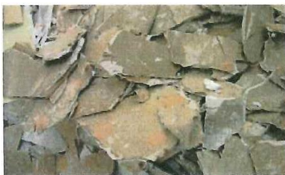
解体系廃石膏ボード
